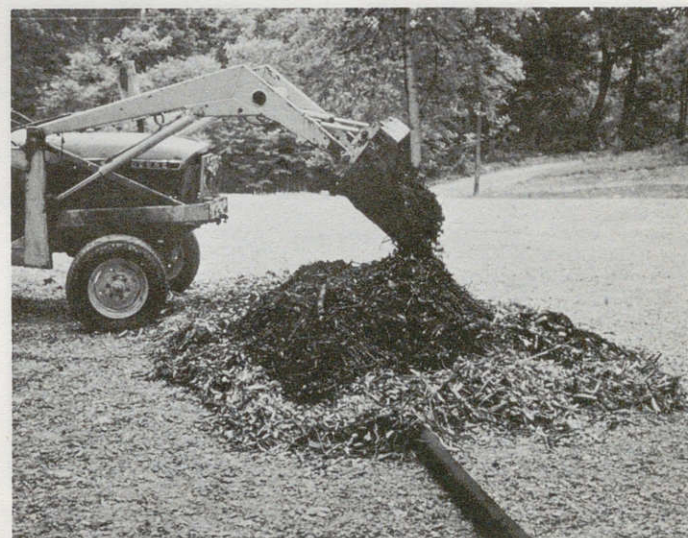
Soigneusement mélangés, déchets et liants sont transférés sur le caillebotis.
