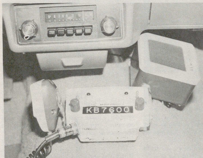
Fig. 1. Der.: Teléfono, micrófono externo y control remoto para una estación base de radio. Fig. 2. Abajo: Control principal, micrófono y parlante para una unidad móvil de radio sobre camión, y el receptor y transmisor de la radio móvil montada en el baúl o área de equipaje de un vehículo.
