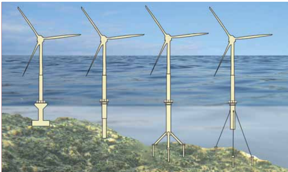
Figure 4: Options de fondations offshore – la figure montre les quatre principaux types de fondations pour les éoliennes offshore. De gauche à droite: gravitaire, monopile, tripode et flottante. © C. Wilhelmsson.
